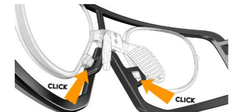
4 premere per agganciare il clip push to assemble the clip
