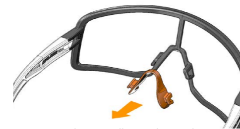
1 rimuovere l'appoggio naso in gomma remove the rubber nose pad
